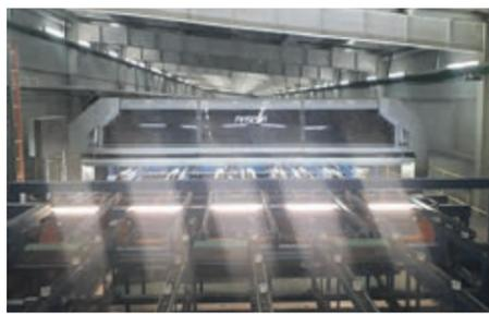
Система BoardMaster, установленная в Вельском ЛПК в цехе сортировки и пакетирования сухих пиломатериалов, скани-
