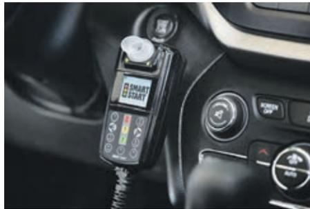
В Устьянском ЛПК в ближайшее время будут протестированы алкозамки, встроенные в технику предприятия. Благодаря нововведению пуск двигателя автомобиля без предварительного прохождения проверки состояния водителя через алкотестер будет невозможен. Напомним, что ранее прибор был протестирован в Вельском ЛПК и показал свою эффективность. На сегодня оборудование доработано с учетом пожеланий Группы компаний УЛК.
